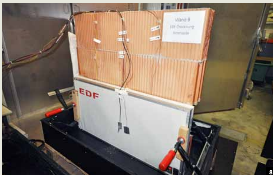
Abb. 6: Drei Wochen dauerte die Folienzelttrocknung im Labor, wofür 40,6 kWh/kg w benötigt wurden.
