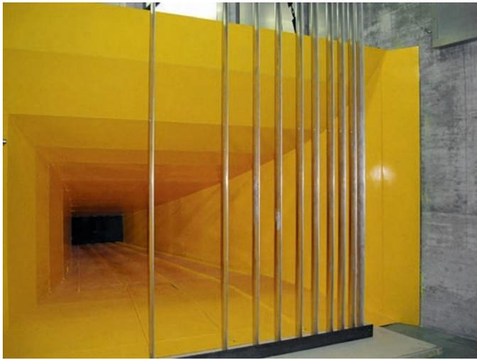
Bild 8. Lamellenvorsatz für eine Fassade, eingebaut im Anschluss an den Expansionstrichter.
