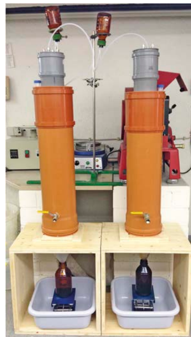
Bild 1. Aufbau der Säulenversuche. Fig. 1. Experimental setup.
