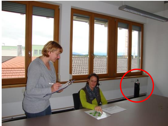
Abbildung 51: Bewertung der Luftqualität in einem Referenz-Büro (roter Kreis: Hochleistungsionisator)
