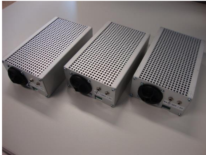
Abbildung 45: Datenlogger (enthalten MOX-Sensoren, Batteriebetrieb, Temperatur- und Feuchtesensor, Real-Time-Clock und SD-Karte)
