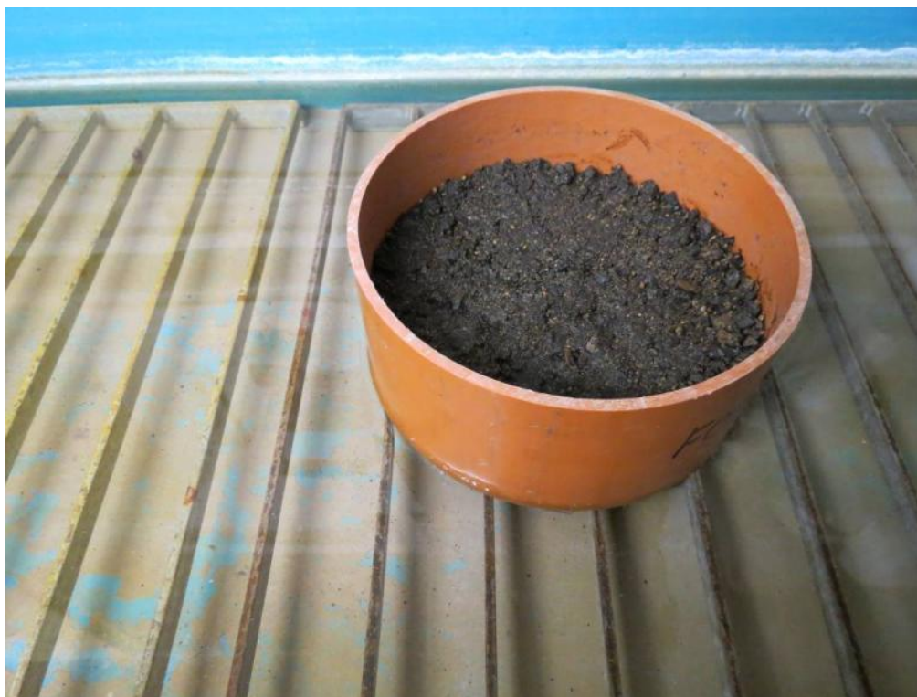
Bild 49: Fotografische Aufnahme des Versuchsaufbaus zur Bestimmung des Wasseraufnahmekoeffizienten (oben: vor dem Kontakt mit Wasser, unten: gegen Ende des Versuchs nach dem Vollsaugen der Probe).
