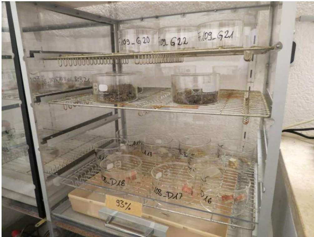
Bild 56: Fotografische Aufnahme des Versuchsaufbaus zur Bestimmung der Sorptionsfeuchte (hier bei 93 % relativer Feuchte).
