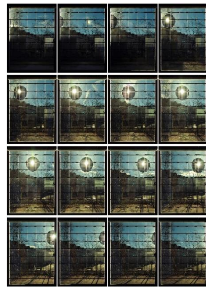
Abbildung 9.7: Exemplarische Schaltzustände einer TN-Verglasung mit vertikal gradier-tem Verlauf (links: Außenansicht) und zeitgesteuerter Sonnenstandsnachführung (rechts: Sequenz einzelner Innenansichten der Verglasung mit Verdunkelung im Bereich der Sonne)
