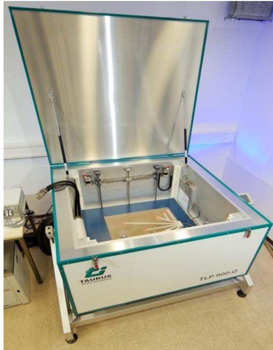
Bild 4: Foto des verwendeten schwenkbaren Plattengeräts (Fraunhofer IBP, Standort Stuttgart, Gruppe Wärmekennwerte und Klimasimulation).
