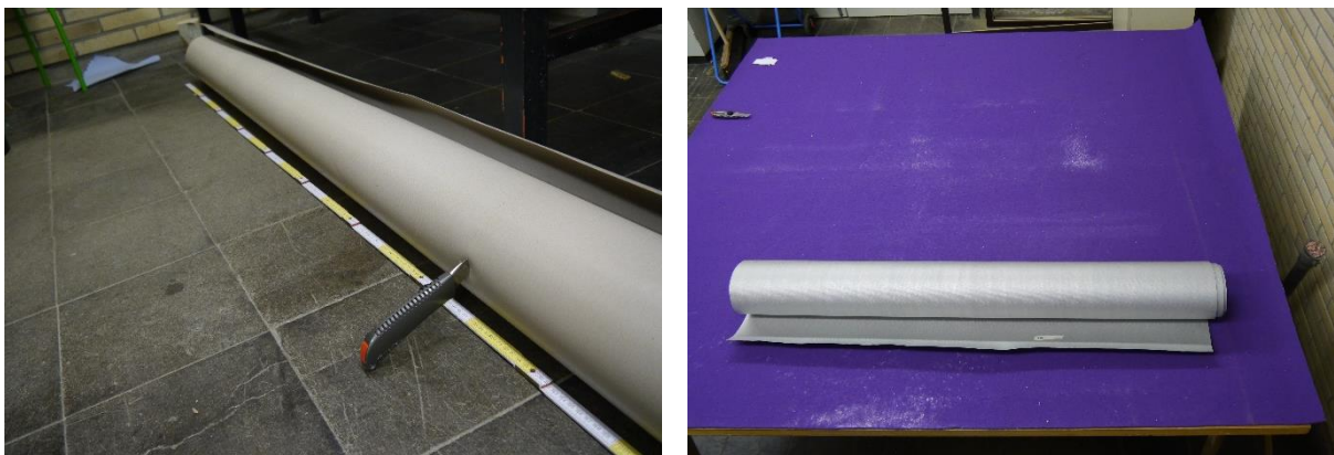
Abbildung 4.9: Membranrolle vor dem Grobzuschnitt (linkes Bild), vorkonfektionierte Probe nach dem Grobzuschnitt (rechtes Bild)
