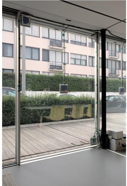
Abbildung 4.34: Sensorpositionen im Systemachsenbereich C der Vakuumglasfassade
