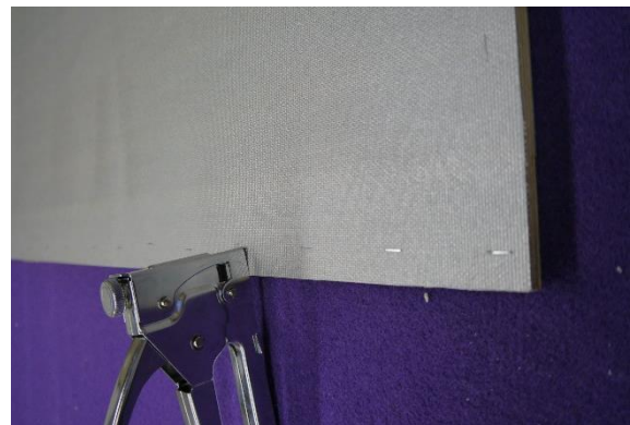
Abbildung 4.12: Konfektionierte Probe auf Rahmen (linkes Bild), zusätzliche mechanische Befestigung der Membrane auf dem Montagerahmen (rechtes Bild)
