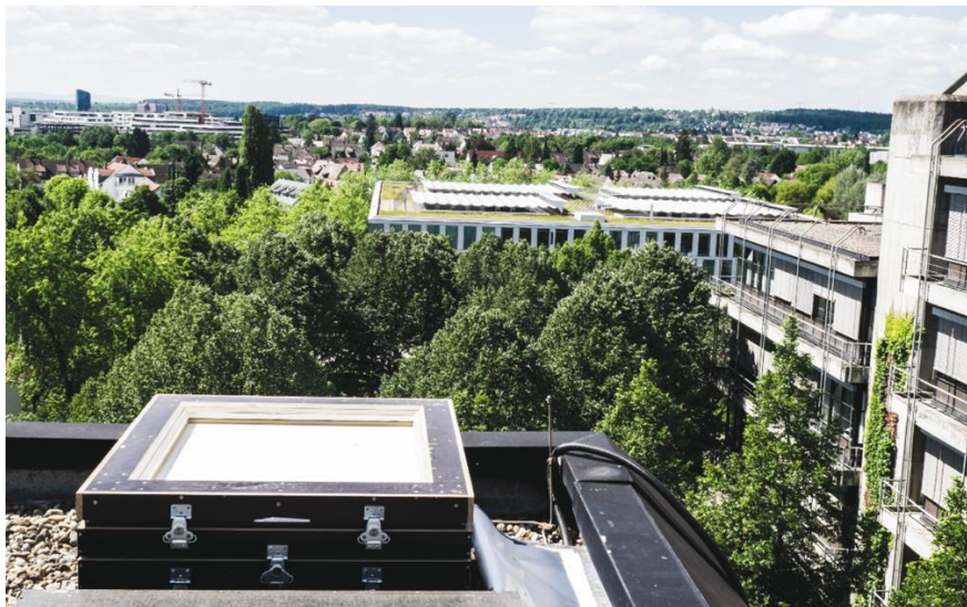
Abbildung 4.14: Prüfkasten des Dachprüfstandes, Pfaffenwandring 7, Stuttgart
