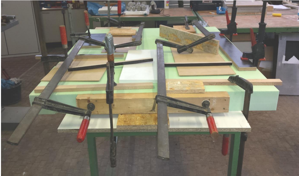
Abbildung 4.4: Referenzprobekörper während des Aushärtens des Klebstoffes
