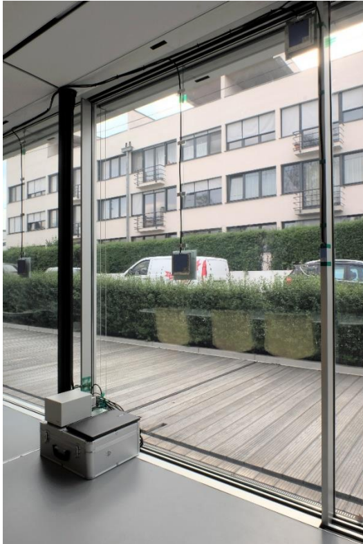
Abbildung 4.34: Sensorpositionen im Systemachsenbereich C der Vakuumglasfassade
