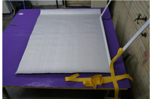
Abbildung 4.10: Vorabkennzeichnung der Probe (linkes Bild), Entfernen der Schutzfolie des doppelseitigen Klebbands vor dem Aufbringen des Montagerahmens auf die Probe (rechtes Bild)
