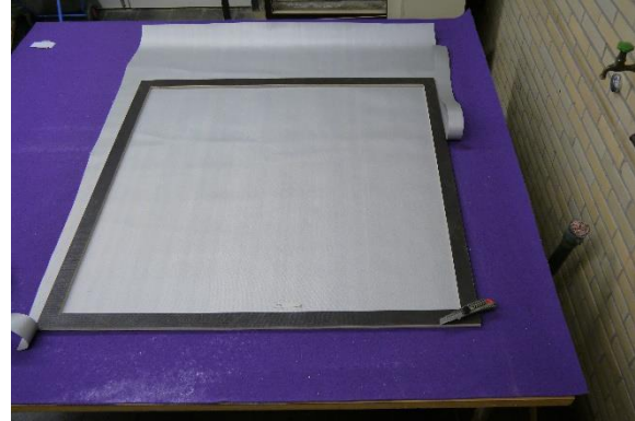
Abbildung 4.11: Aufkleben des Montagerahmens auf die Probe (linkes Bild), Formatschnitt der Probe (rechtes Bild)
