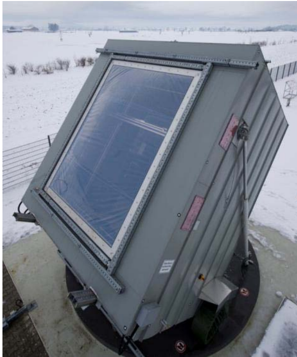
Bild 17: Messbox des kalorimetrischen Fassaden- und Dachprüfstands mit einem pneumatisch gestützten, zweilagigen ETFE-Membrankissen in der Prüflingsöffnung.
