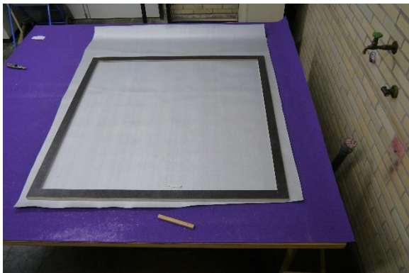
Abbildung 4.11: Aufkleben des Montagerahmens auf die Probe (linkes Bild), Formatschnitt der Probe (rechtes Bild)
