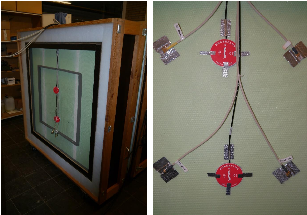
Abbildung 4.8: Warmseite der Hotbox mit eingebautem Referenzprobekörper (linkes Bild), auf dem anschließend die Sensoren befestigt wurden (rechtes Bild)
