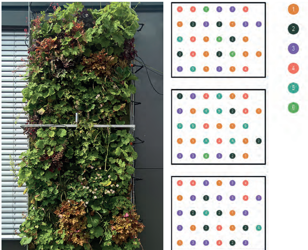
Abb. 49 Fassadeversuchsstand – Variante 1: Vertiko GmbH, Buchenbach mit Pflanzplan (THN-AR) (Pflanzliste vgl. Tab. A10 im Appendix)
