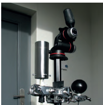
Abb. A14 Innenraumtemperatur Globethermometer (THN-AR)
