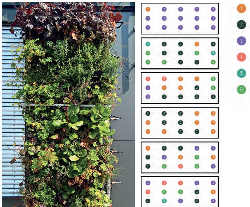
Abb. 51 Fassadenversuchsstand – Variante 3: Kramer, München mit Pflanzplan (THN-AR) (Pflanzliste vgl. Tab. A12 im Appendix)
