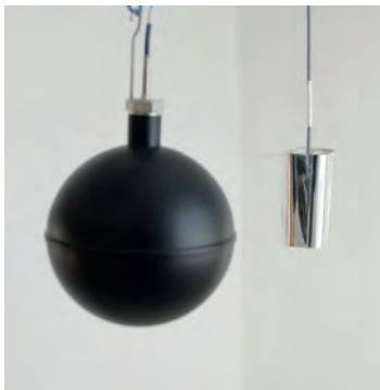
Abb. A45 Globethermometer und Lufttemperatursensor mit Strahlungsschirm (IBP)
