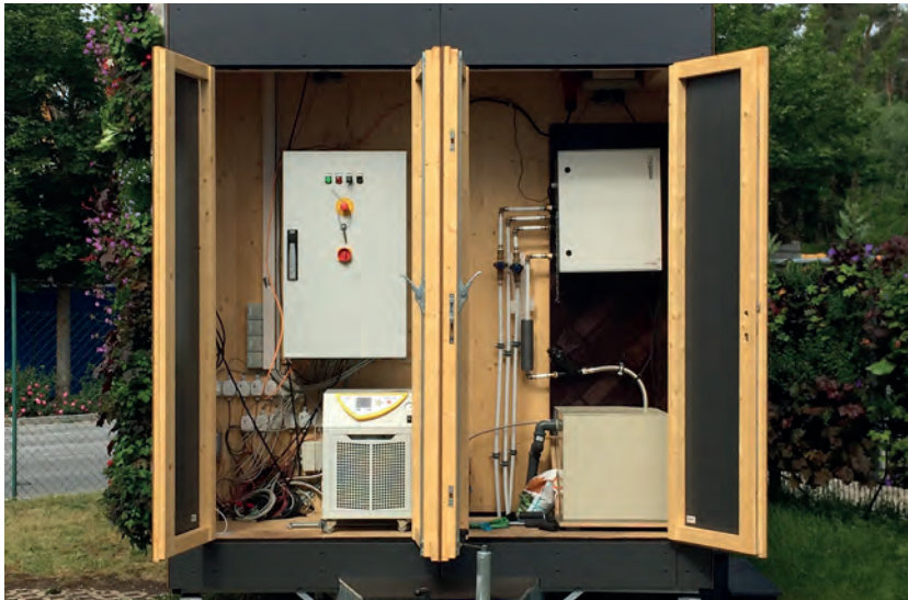
Abb. 48 Rednitzhembach, Technikum/ Fassadenversuchsstand, Technikraum – Bewässerungsanlage rechts (THN-AR)
