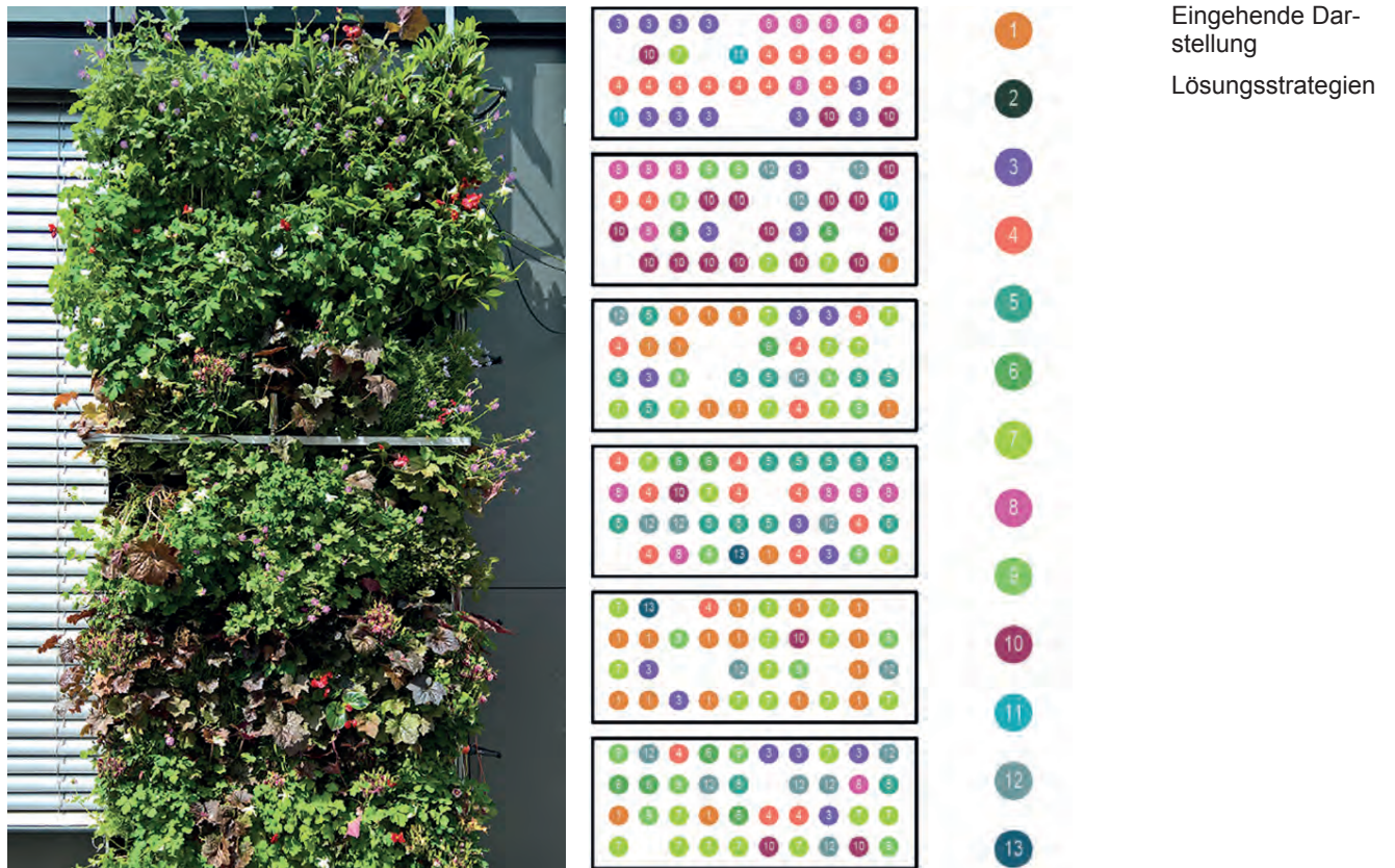
Abb. 50 Fassadenversuchsstand – Variante 2: Verticalgreendesign (VGD), Berlin mit Pflanzplan (THN-AR) (Pflanzliste vgl. Tab. A11 im Appendix)
