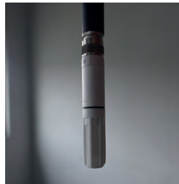
Abb. A47 Kapazitiver Feuchte-sensor (IBP)
