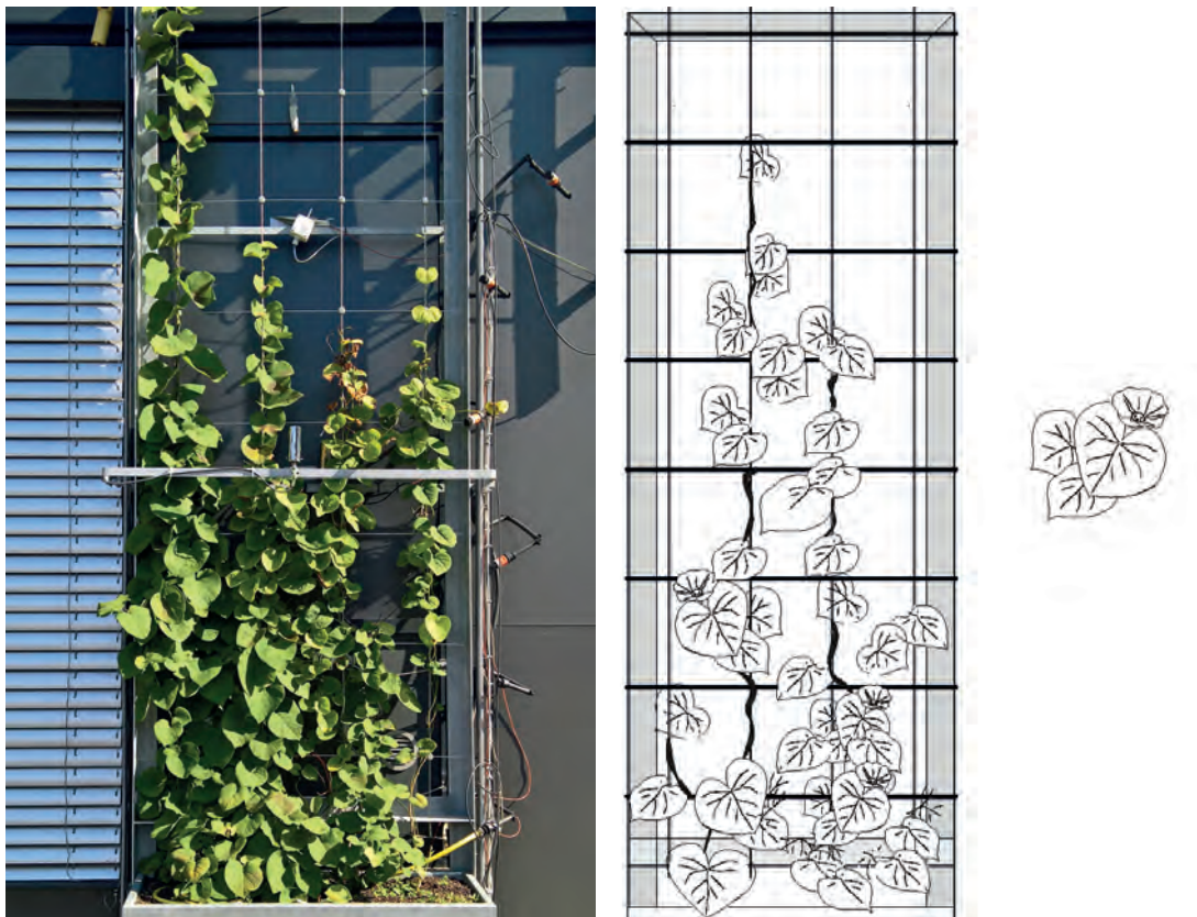
Abb. 52 Fassadenversuchsstand – Variante 4: Jakob Rope Systems, Ostfildern mit Pflanzplan (THN-AR) (Pflanzliste vgl. Tab. A13 im Appendix)
