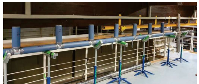
Abbildung 3: Periodische Resonatoranordnung eingebaut im Schalldämpferprüfstand am Fraunhofer IBP in Stuttgart.
