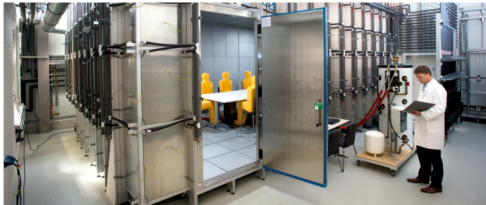
Prüfraum außen mit modularen Heiz-/Kühlfeldern. © Fraunhofer IBP
