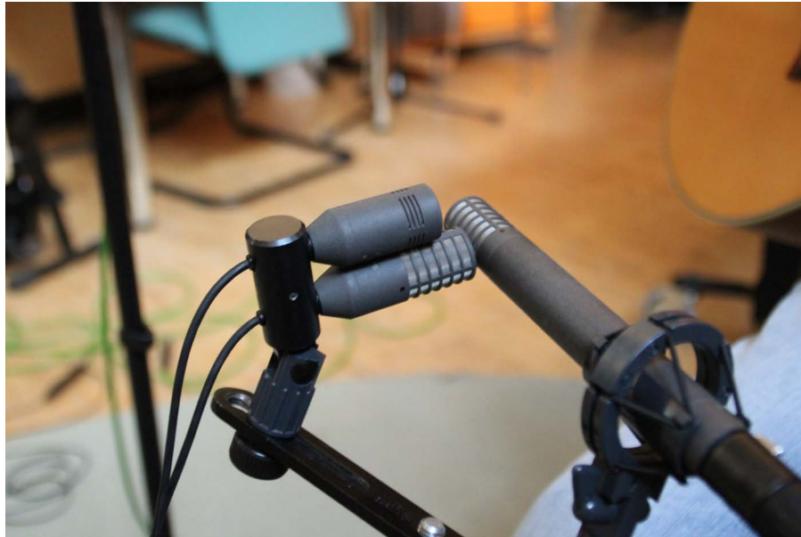
Abbildung 5.1: Mikrofonanordnung MHV auf Stereoschiene für Vorversuche.
