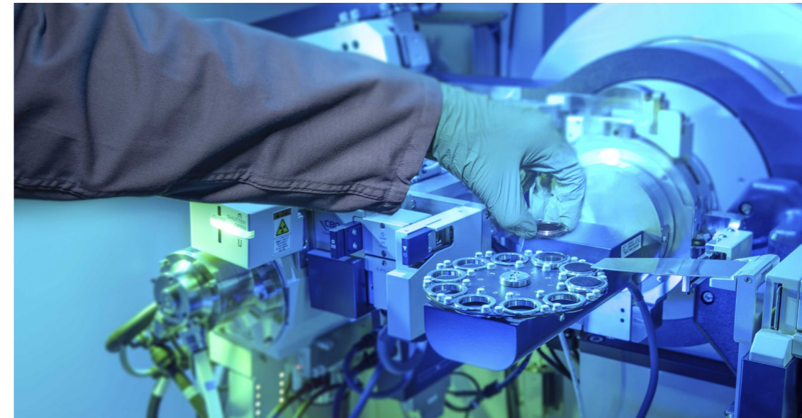
Smart Lab zur Röntgenanalytik: Die Proben werden in den automatischen Probenwechsler gesetzt und röntgenographisch analysiert.
