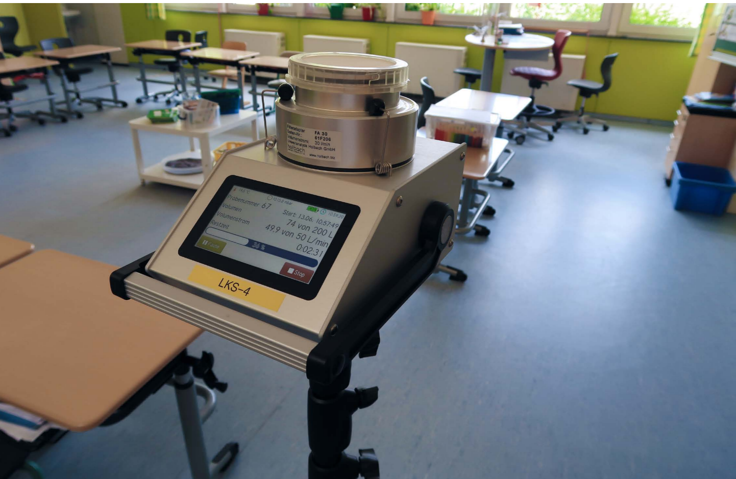
Luftkeimsammler mit Gelatinefilter unmittelbar unterhalb von einem der beiden Raumlufreiniger
