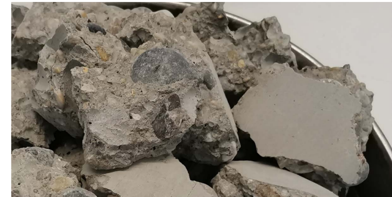
Betonbruch vor Behandlung mittels elektrodynamischer Fragmentierung
