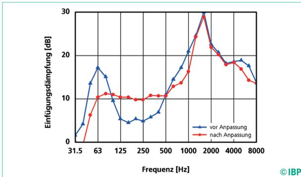
Bild 3: Einfügungsdämpfung vor und nach Anpassung des Kompaktschalldämpfers.
