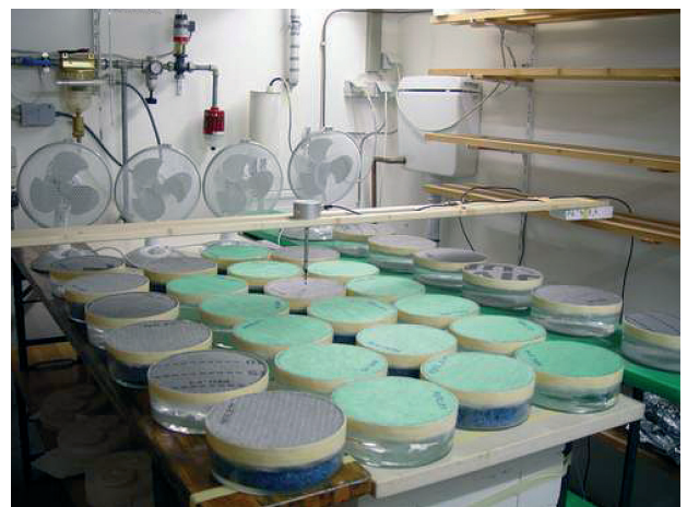
Bild 1: Versuchsaufbau zur Ermittlung des Einflusses der Überströmgeschwindigkeit [2].
