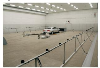
Bild 3: Halb-Freifeld-"Pass-by"-Messhalle (3454 m³), ausgekleidet mit 620 mm tiefen ASA + VPR im Akustik-Zentrum von VW [6].
