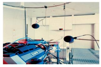
Bild 4: Freifeld-Motor-Akustik-Prüfstand (338 m³) ausgekleidet mit 250 mm tiefen BKA im Forschungs- und Ingenieur-Zentrum von BMW [7].
