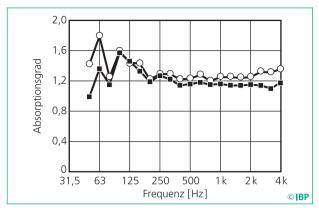
**Bild 2:** Absorptionsgrad  $\alpha_s$ , gemessen nach ISO 354, für 250 mm dicke BKA (  $\blacksquare$  ) und insgesamt 620 mm dicke VPR+ASA (  $\bigcirc$  ) auf Melaminharz-Basis mit 1 mm Stahlblech.
