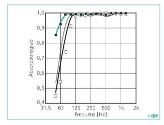
**Bild 1:** Absorptionsgrad  $\alpha_0$  verschieden strukturierter poröser/faseriger Schallabsorber, gemessen nach ISO 10534 im Kundt'schen Rohr mit 200 x 200 mm Querschnitt. ASA: 520 ( — ); 650 ( — ); 780 mm ( — ) Keile: 680 (  $\bigcirc$  ); 1075 mm (  $\blacksquare$  ).
