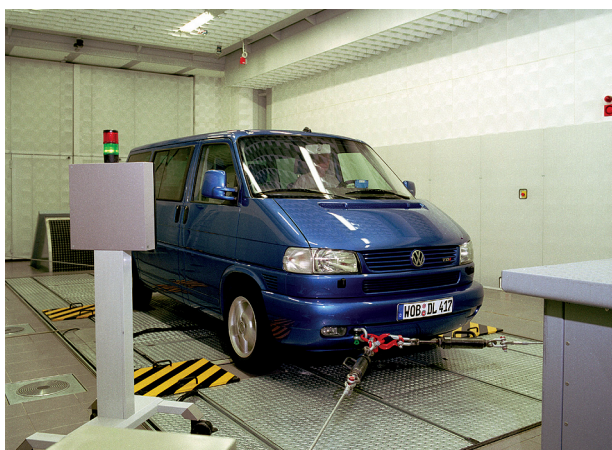
Bild 1: Schallabsorbierend ausgekleideter Allrad-Rollen-Prüfstand.
