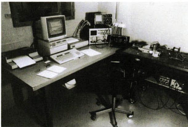
Bild 4: E-Modul-Meß-Labor; von rechts nach links: Meßaufbau mit Verstärkern, Fourier-Analysator und Oszillograf, Drucker, Personal-Computer, Plotter
