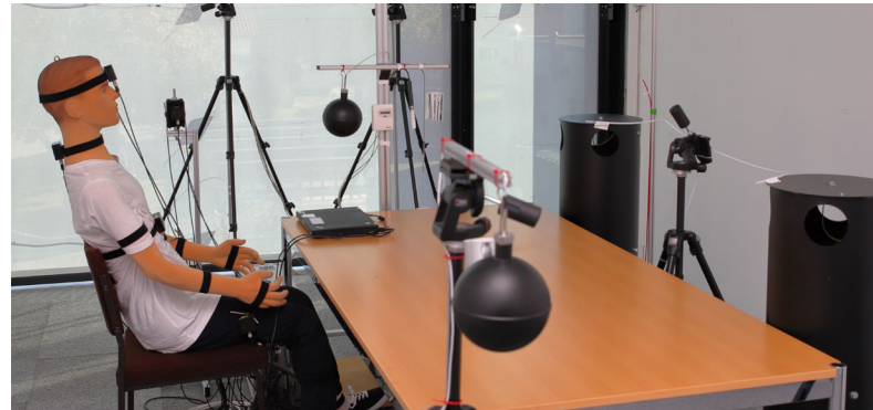
oben: Bewertung der Tageslichtverhältnisse mit der Software DIALux Evo, unten: Testraum mit Klimamesspuppe DressMAN zur Bewertung des thermischen Komforts © Fraunhofer IBP
