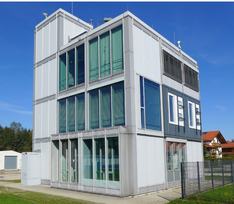
Versuchseinrichtung für energetische und raumklimatische Untersuchungen VERU © Fraunhofer IBP
