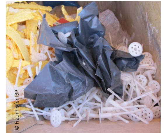
Reststoffe wie Dübel, Bauschaum etc.
