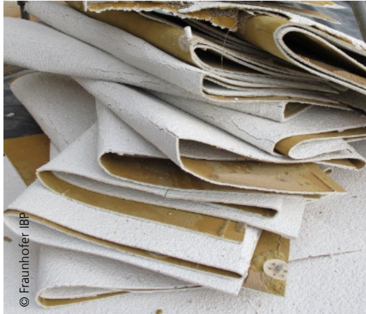
Putz inklusive Schlussbeschichtung und Gittergewebe
