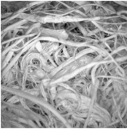
Bild 4. Mikroskop-Aufnahme zur Ermittlung der Faserquerschnitte (Quelle: Fraunhofer-Institut für Bauphysik IBP). Fig. 4. Microscopic picture used for the determination of fiber cross-sections (Source: Fraunhofer-Institut für Bauphysik IBP).
