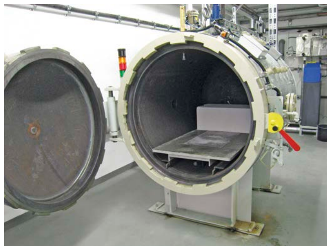
Bild 6. Satteldampfautoklav am Fraunhofer IBP mit etwa 3 m 3 Fassungsvermögen
