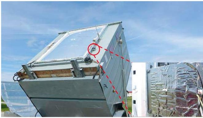
Bild 12. Foto des Kalorimetrischen Fassaden- und Dachprüfstands des Fraunhofer IBP mit Detailausschnitt des außen installierten CHM.
