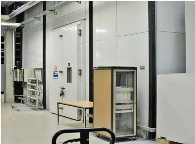
*Bild 9. Klimasimulator in dem ein Versuchsraum mit Innendämmung und Flächenheizungen aufgebaut wurde, von außen.*
