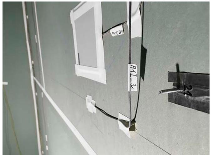
*Bild 11. Eine Detailaufnahme mit CHM (rechts) zur Messung des konvektiven Wärmeübergangskoeffizienten und Wärmestrommesser (links) zur Ermittlung der Wärmestromdichte im Versuchsraum.*
