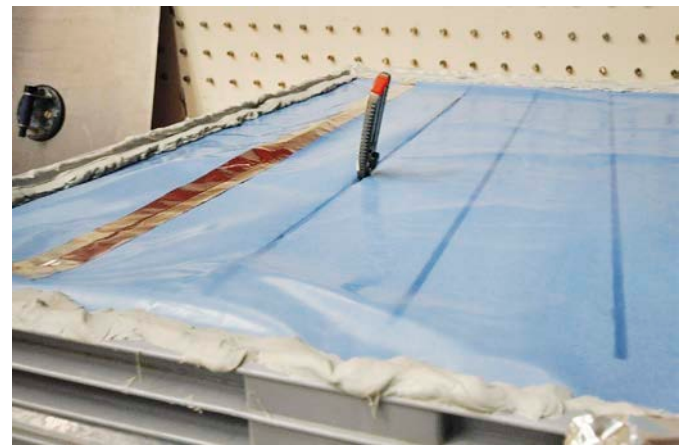
Bild 5. Luftmassenstrommessung von Klebebändern in einer luftdichten Box
