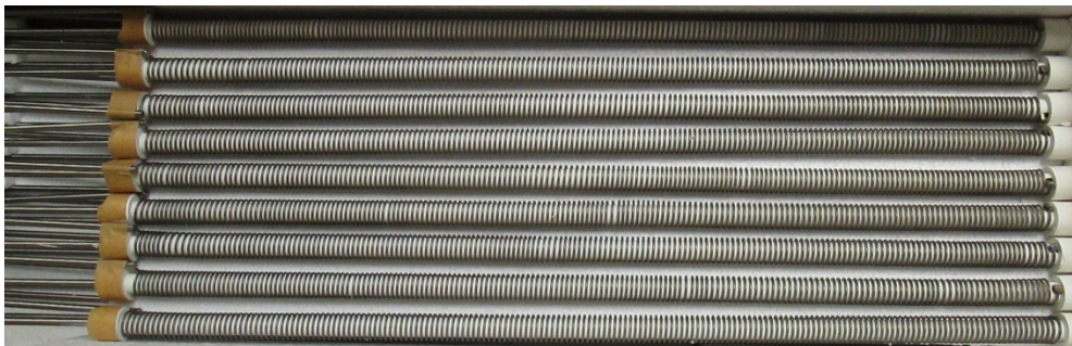
Bild 7: Heizwendeln mit Keramikhülsen als Abstandshalter.
