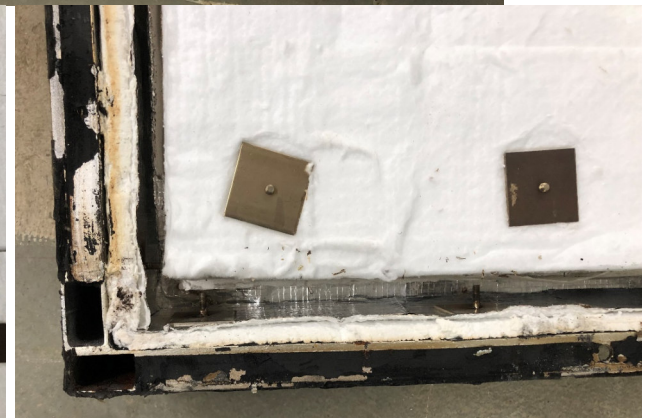
Bild 113: HTSS-Deckel mit der Sammlung von Spül- und Kernluft nach Abschluss der Ver- suche.
