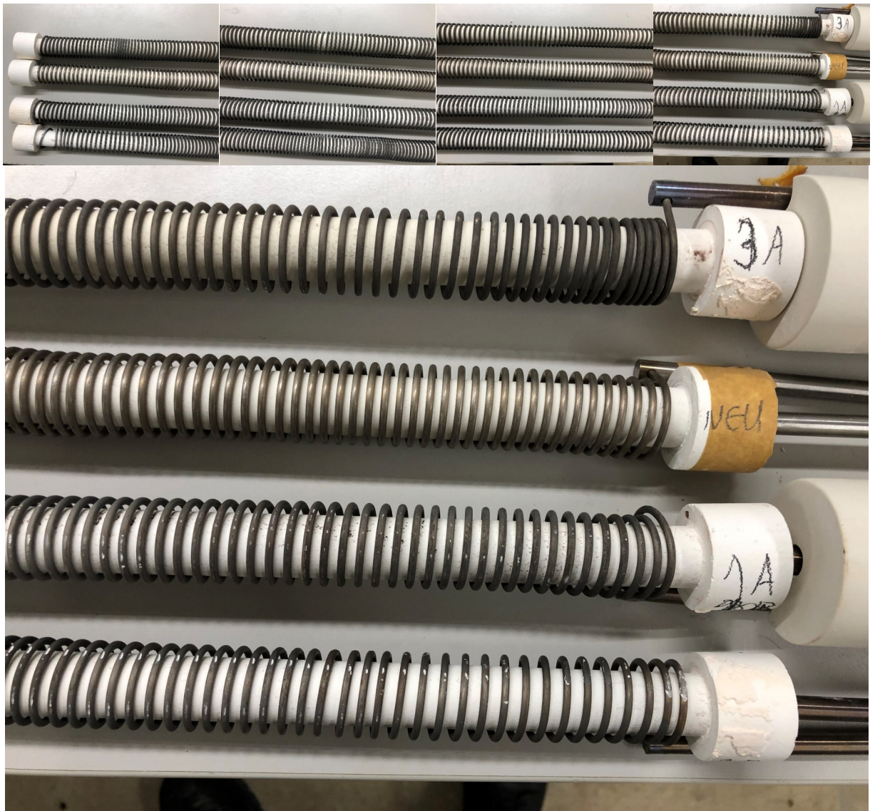
Bild 110: Vergleich der 3 rückgebauten Heizwendeln Nr. 1 (1A), 4(2B) und 7(3A) mit einer ungenutzten Rückstellprobe (NEU).
