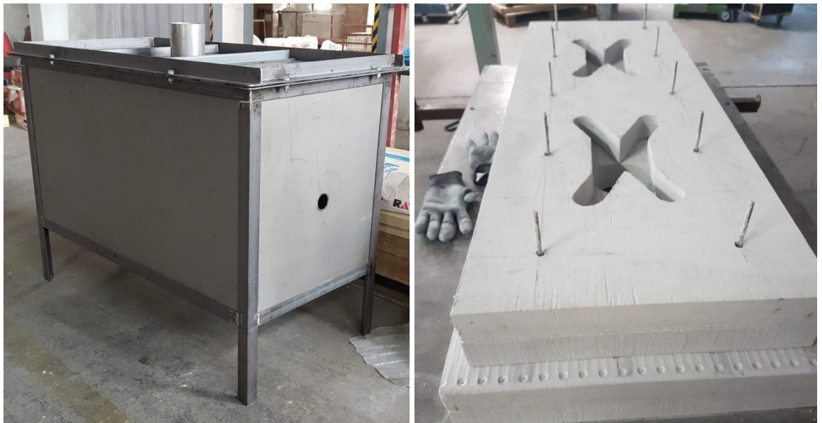
Bild 68: Fotos des realen Aufbaus des Kleinversuchs: Links der fertige Kleinversuch. Rechts die Luftführungs-Steine im Aufbau.
