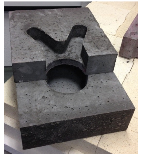
Bild 3: Luftführung im Speicherkern, links und mittig als technische Zeichnung, rechts als Fotografie.
