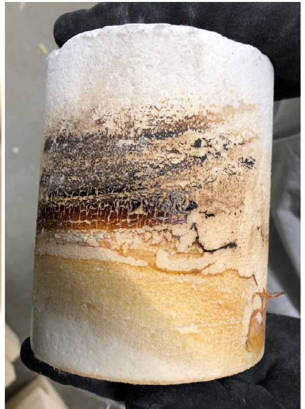
Bild 115: Heizwendelkanal (links) und Keramikfaser-Schutzhülse zur Durchführung der Heizwendel durch den Spülluftspalt (rechts) nach Abschluss der Versuche.
