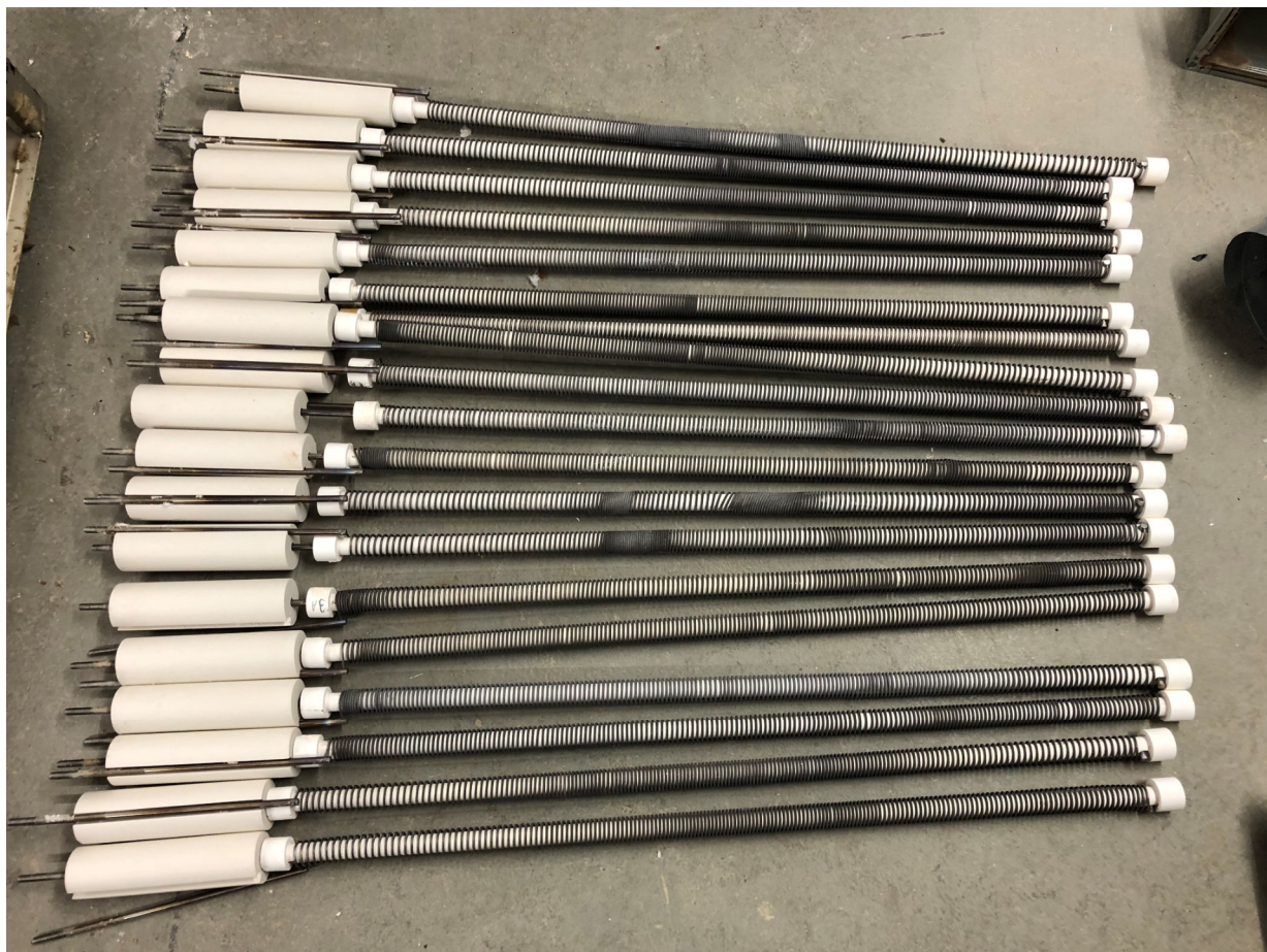
Bild 111: Abbildung aller 18 rückgebauten Heizwendeln.
