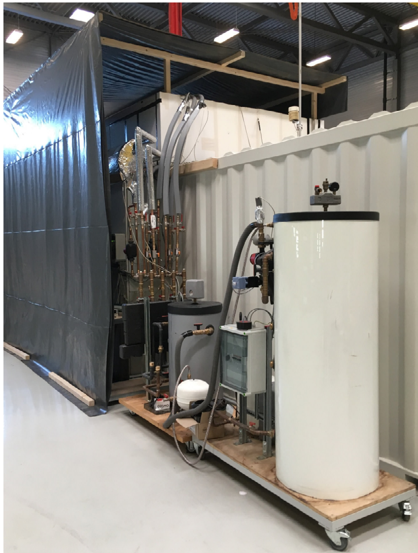
Bild 84: Fotografische Darstellung der hydraulischen Prüflingsversorgung im Technikum des Fraunhofer IBP.
