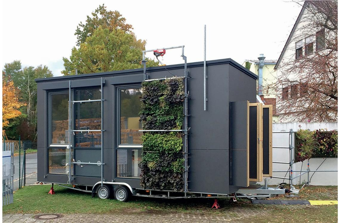
Rednitzhembach, Technikum: EnOB: GreenFaBS-Versuchstand. Referenzbüro mit DFL (links) und Aufbau mit Fassadenbegrünung „Variante 1“ und DFL (rechts) (Quelle: RK)
