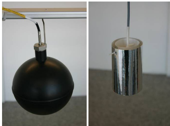
Bild 7: Temperatursensoren zur Bestimmung der operativen Temperatur (linke Bildhälfte) und der Lufttemperatur (rechte Bildhälfte).
