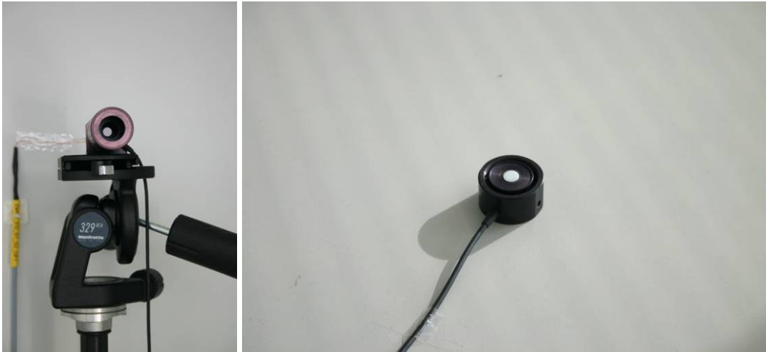
Bild 8: Photometerkopf zur Bestimmung der Leuchtdichte (linke Bildhälfte) und Beleuchtungsstärke (rechte Bildhälfte).
