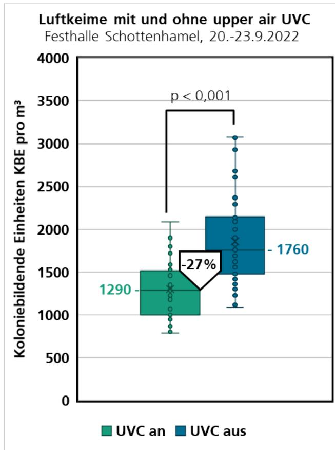
Koloniebildende Einheiten aerober Luftkeime aus der orientierenden Messung in der Festhalle Schottenhamel mit und ohne Einsatz von upper air UVC-Geräten.
