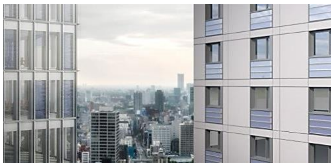
Rendering eines Gebäudepanoramas mit den Entwicklungen aus dem ArKol-Projekt: solarthermische Jalousie (links) und Streifenkollektor (rechts). © IBK2
