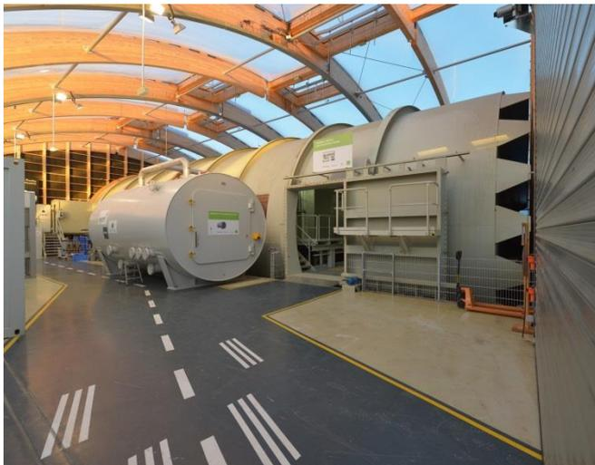
**Die Thermal Test Bench mit dem dazugehörigen AirCraft Calorimeter ist ein thermischer Prüfstand und erschließt den Wissenschaftlern am Fraunhofer IBP neue Forschungsmöglichkeiten für die Luftfahrtindustrie.**
