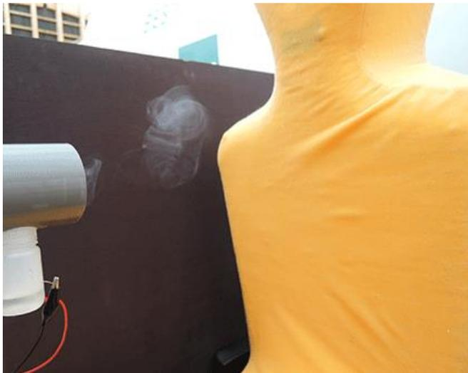
**Der im Wirbelringgenerator erzeugte Vortexring bewegt sich auf den Dummy zu.**
