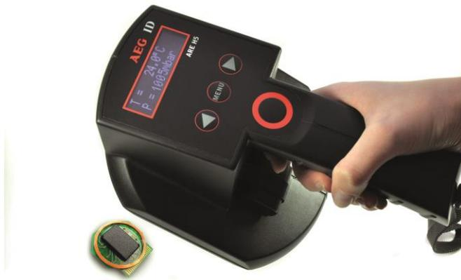
**Das Fraunhofer IMS hat ein Sensorsystem mitentwickelt, das Feuchte und Korrosion im Beton erfasst.**
