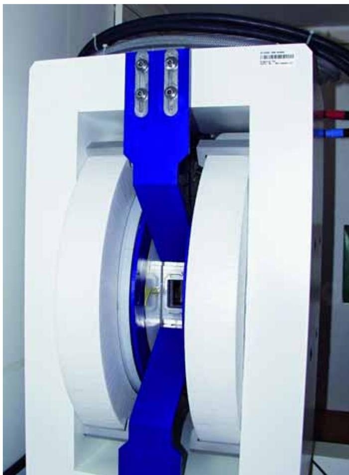
Ansicht des NMR-Magneten mit Messkopf
