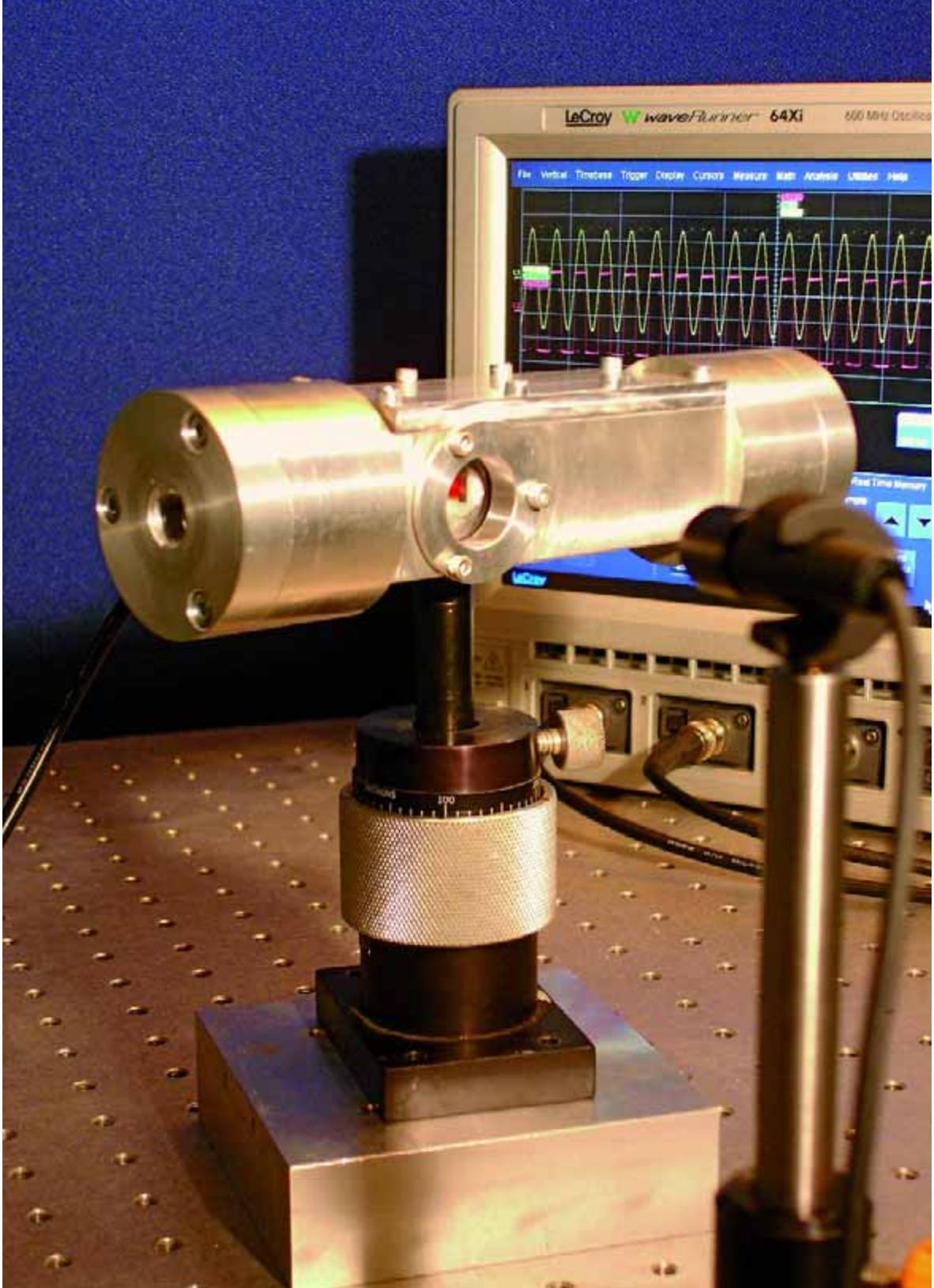
Erfassung des photoakustischen Signals mittels eines am Institut entwickelten Detektors
