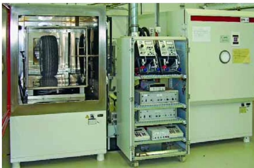
SHED-Prüfkammern mit FID Analysatoren, in der linken Kammer läuft eine Reifenanalyse
