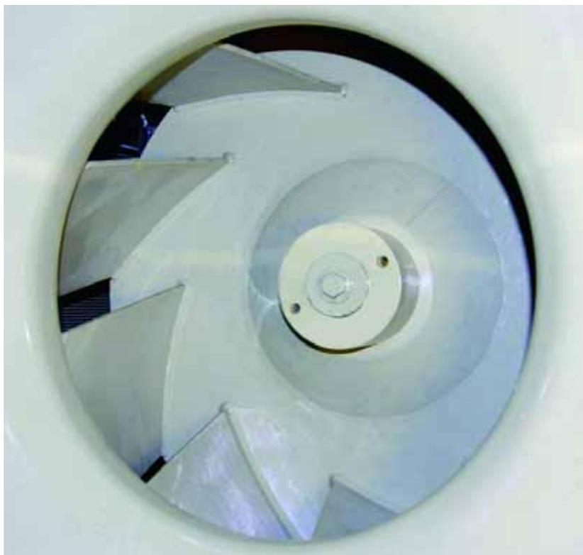
Ventilator eines Kühlturms für E-Loks, auf dessen Luftansaugseite aktive Schalldämpfer integriert wurden.
