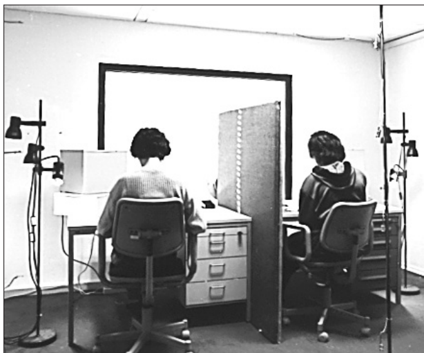
Bild 1: Photo des Versuchsaumes mit Versuchspersonen. Der Quellluftdurchlaß besteht aus einer perforierten Fußleiste an der Außenwand. Die Kühldecke wird von Kühlelementen gebildet.
