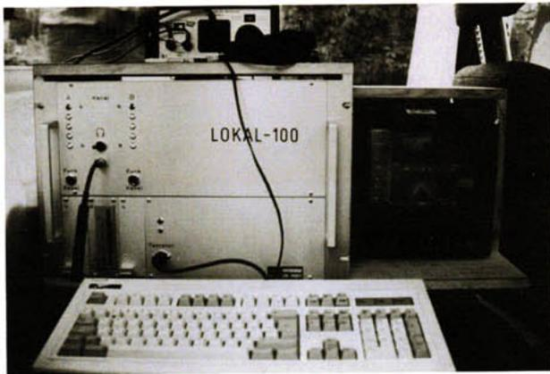
Bild 2: Erstes serienmäßiges LOKAL-Kompaktgerät
