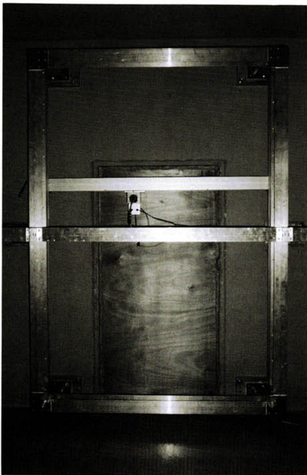
Bild 4: 3-Achsen-Positioniervorrichtung an einem Testobjekt im Türen-Prüfstand des IBP
