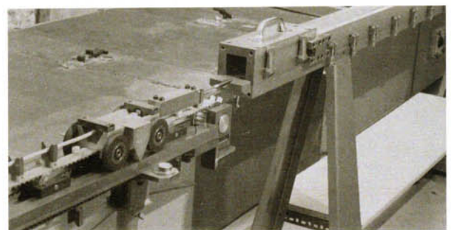
Bild 2 Meßanordnung mit Probeneinbau im Kundt'schen Rohr und Meßwagen mit Sondenmikrofon.
