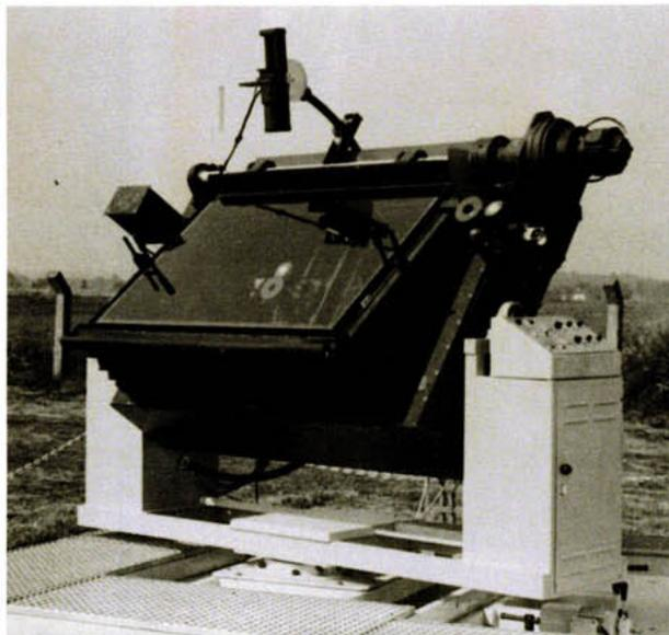
Mit Hilfe des beschriebenen Gerätes kann somit der Transmissionsgrad des kompletten transmittierenden Bauteils direkt gemessen werden. Zur Ermittlung des Wärmeabgabegrades werden die Absorptionsgrade der einzelnen Schichten des Bauteils durch Messung deren integralen Transmissions- und Reflexionsgrade bestimmt. Anschließend wird der Wärmeabgabegrad in Anlehnung an die DIN 67507 berechnet.
