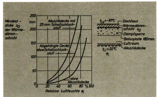
Mindestdicke der Wärmedämmschicht ( $\lambda = 0,035 \text{ kcal}/(\text{m h K})$ ) über der Dampfsperre eines Flachdaches mit untergehängter Akustikdecke ( $1/\Lambda = 0,7 \text{ m}^2 \text{ h K}/\text{kcal}$ ) abhängig von der rel. Luftfeuchtigkeit im Raum unter der Decke, um Kondensat in der Konstruktion zu vermeiden.
