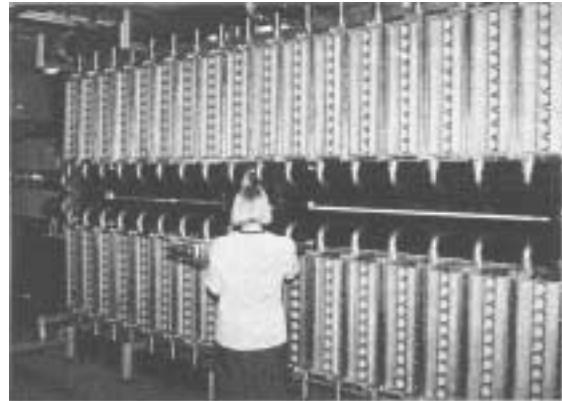
Bild 12 Fotografische Aufnahme des Schimmelpilz-Prüfstandes des Fraunhofer-Instituts für Bauphysik.
