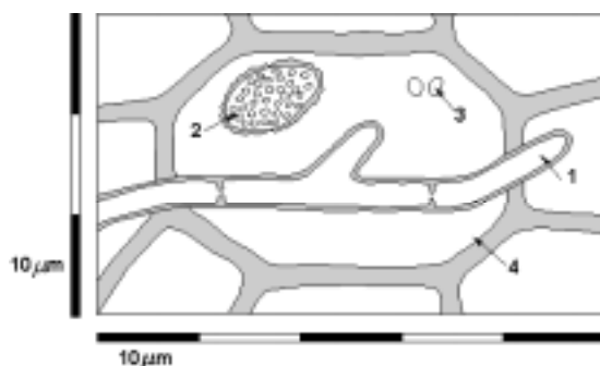
Bild 2 Schematische Darstellung der Größe einer Pilzhyphe (1), einer Pilzspore (2), Bakterien (3) und einer Zelle einer höheren Pflanze (4), nach [116].
